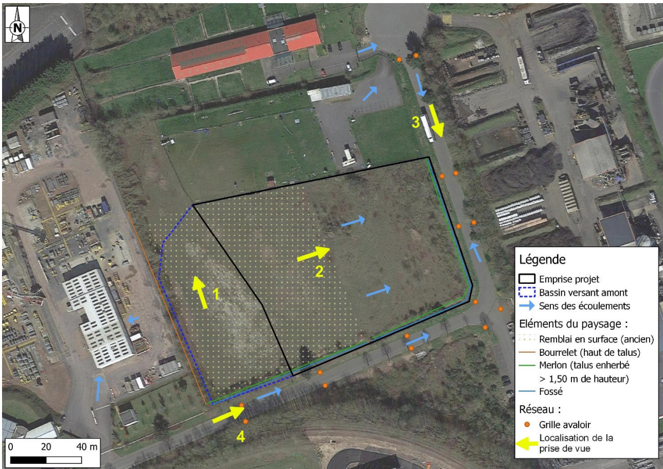
Figure 5 : Fonctionnement hydrologique au droit du site d'étude (Source : BD Ortho de l'IGN avec annotations GINGER BURGEAP)
